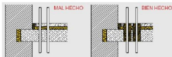
Los bajantes de aguas y las tuberías de calefacción que atraviesan el forjado deben aislarse del mismo mediante la instalación de un revestimiento en forma de coquilla en el caso de tuberías o con paneles en el caso de conductos rectangulares.
