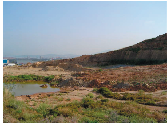
Figura 10.10.: Vista parcial de una de las explotaciones de áridos en el entorno del Cerro de la Pólvara. Se pueden apreciar los taludes provocados por la extracción y la acumulación de desechos. Fuente: Elaboración propia.
