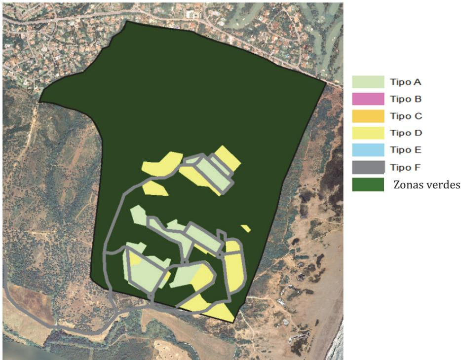
Figura 17. Zonificación acústica del área de estudio, tras el Plan Parcial del Sector 01-GL Guadalquitón.
